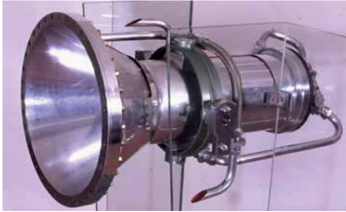
Photo 2 : Le moteur SEPR de l'étage Astris (Photo Snecma)
