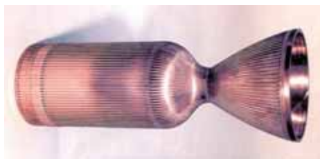
Photo 4 : Le corps de chambre en alliage de cuivre (Photo MBB)
