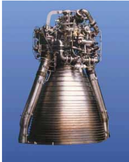
Photo 15 : Le moteur Vulcain (Photo Éric Forterre - Snecma)
