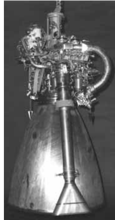
Photo 9 : Le moteur HM7 (Photo Snecma)
